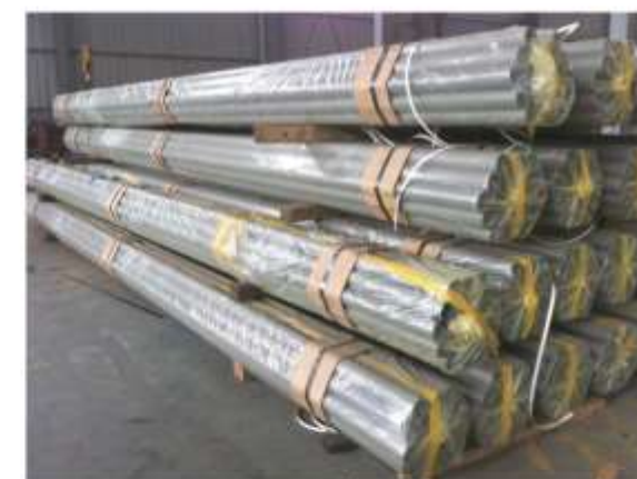
抛光管包装：使用塑料薄膜套装钢管，防止包装袋在运输中因颠簸摩擦划伤钢管外表面。
