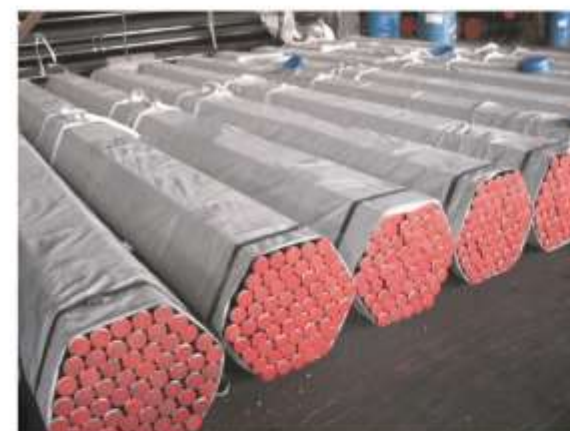
六角形包装：编织布包装、铁皮打捆、两头加盖塑料封头。适用于产品规格单一的小规格不锈钢管包装、适用于汽运、火车运输。
